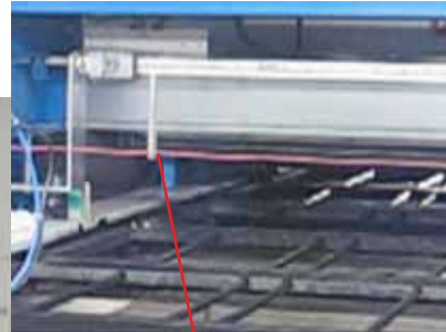
Flachdüse NT 45 auf Linearachse (Beispiel: Reinigung vor Lackierung)
