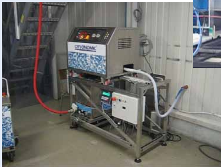
Automatische Produktion von Trockeneis pellets mit automatischer Strahlanlage
