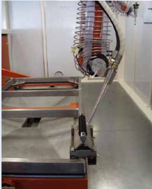
Roboterreinigung in Strahlkabine
